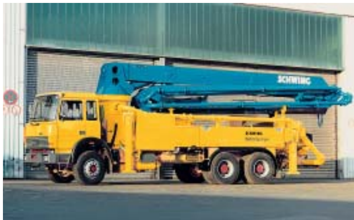
Betonpumpe von Schwing.
