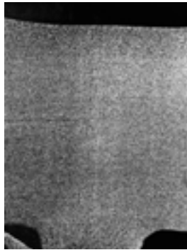
Bild 3. HFI-Schweißnaht, Schweißzustand nach Wärmebehandlung
